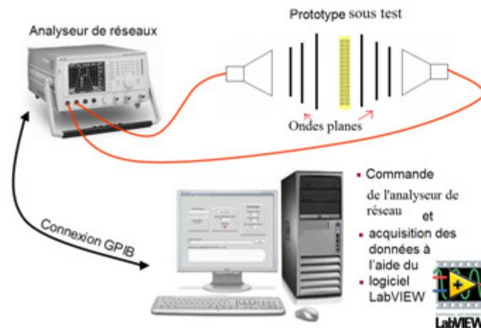
Banc de mesure en espace libre opérationnel entre 8,2 GHz et 12,5 GHz
