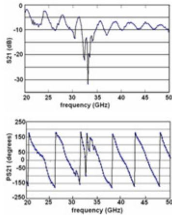
Ligne suspendue en haute fréquence et mesure du signal  $S_{21}$  en amplitude et phase d'une structure à 35 GHz
