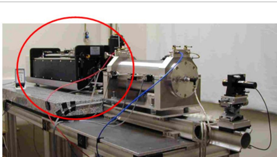
Spectromètre à réseau
